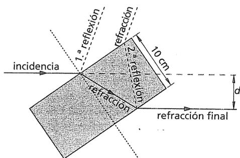
**32 PAU** Un haz monocromático incide con cierto ángulo sobre una lámina de material transparente de caras planas y paralelas de 15 cm de espesor. Se observa que el ángulo de refracción del haz en el interior del material es de  $30^\circ$  y que al salir de él muestra un desplazamiento de 8 cm. Determina:
